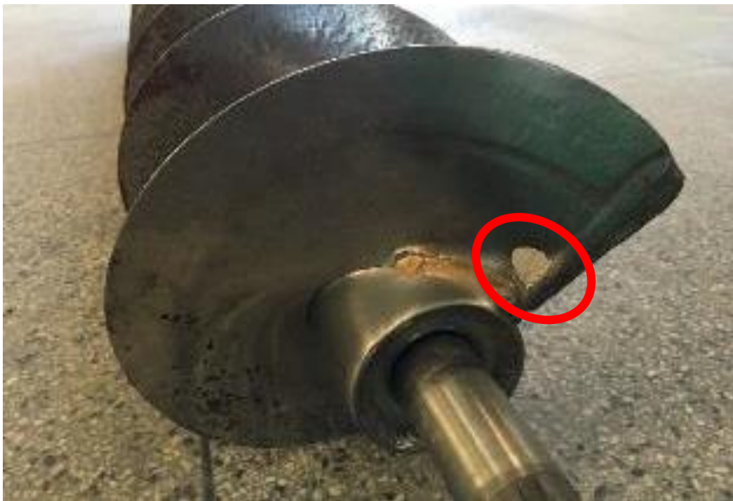
Figura 4 - Mecanismo de transporte desgastado devido à abrasão.
