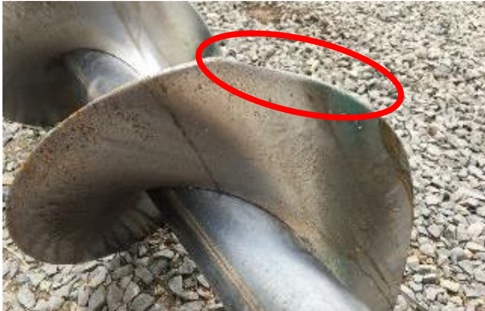
Figura 5 - Mecanismo de transporte helicoidal após aproximadamente 300 horas de uso.
