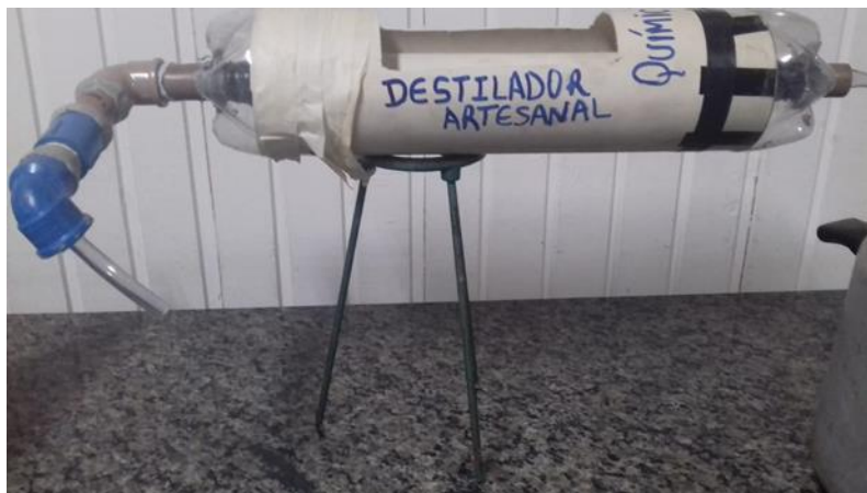
Figura 32- Condensador alternativo para o modelo usando panela de pressão
