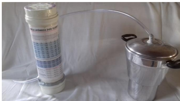
Figura 34- Destilador usado para extração do óleo essencial da folha de laranja
