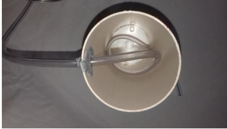
Figura 6 – Fixação da mangueira dentro do condensador
