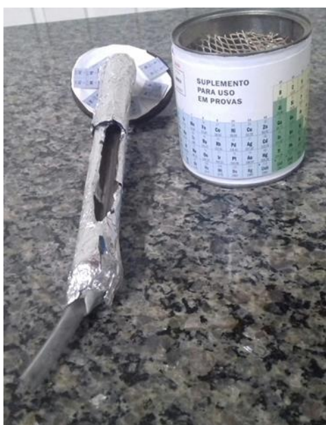
Figura 29- Destilador construído com lata de café
