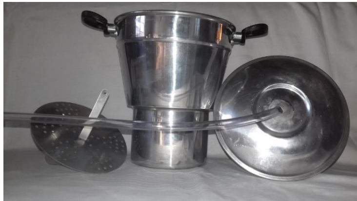
Figura 5- Organização da cuscuzeira para montagem do destilador
