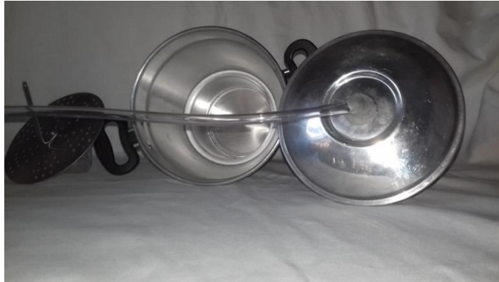
Figura 4- Fixação da mangueira para nível na tampa da cuscuzeira
