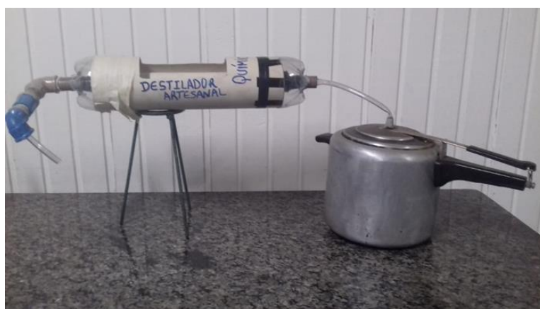
Figura 33- Destilador usando uma panela de pressão
