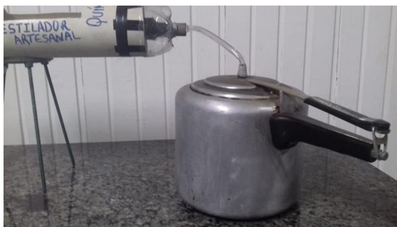
Figura 31- Panela de pressão para construção do destilador
