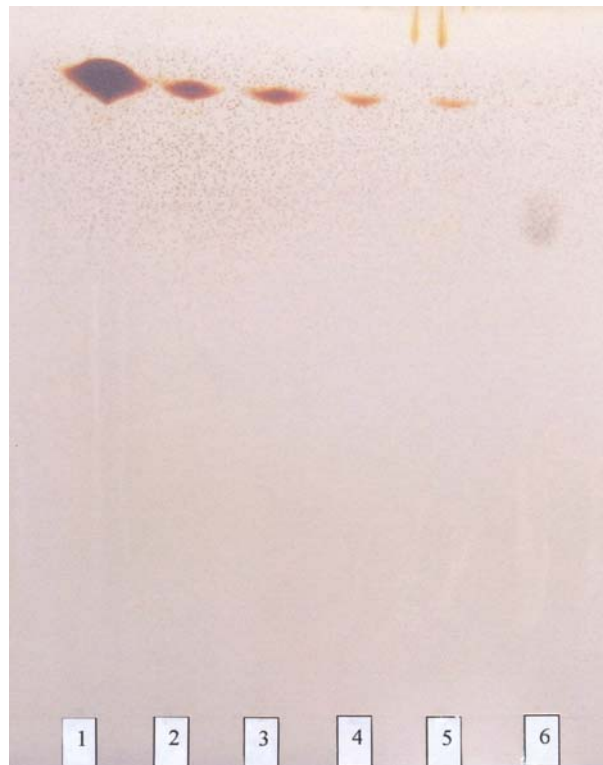
FIGURA 10 – Análise cromatográfica de cloridrato de amiodarona. Fase fixa: sílica gel GF 254 , fase móvel: ácido fórmico, metanol e cloreto de metileno (5:10:85) (V/V). 1: Cloridrato de amiodarona matéria-prima 100 mg/ml; 2: Cloridrato de amiodarona matéria-prima 5 mg/ml; 3: Cloridrato de amiodarona padrão 5 mg/ml; 4: Cloridrato de amiodarona matéria-prima 0,5 mg/ml; 5: Cloridrato de amiodarona matéria-prima 0,25 mg/ml; 6: Cloridrato de (2-cloroetil)dietilamina 0,2 mg/ml.
