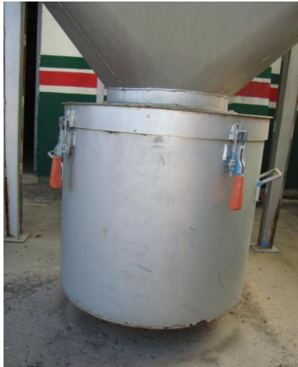
Figura 9 - Fotografia – Reservatório do Filtro de Mangas – Equipamento da COTRISEL. Fonte: Arquivo Pessoal, 2009.
