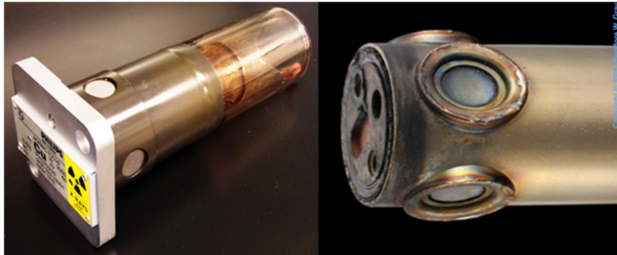
Figura 2.2: (a) Vista externa do tubo de raios x[11]; (b) janelas de berílio.
