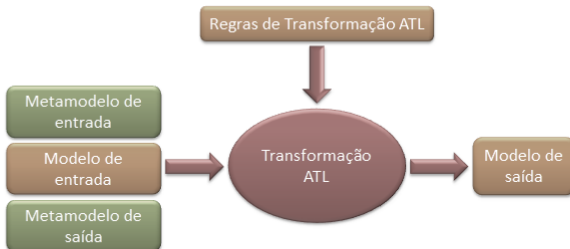
Figura 7 - Funcionamento de transformações em ATL.
