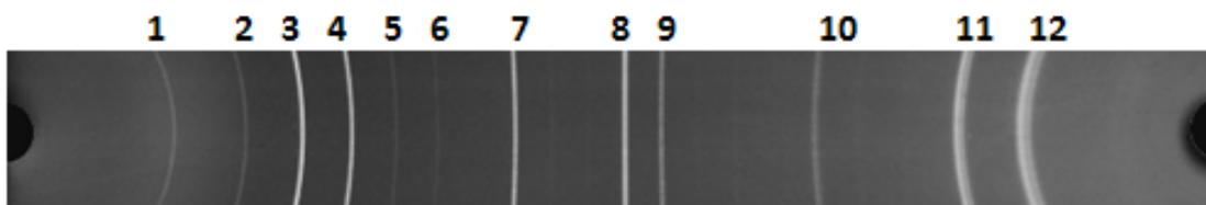
**Figura 27** – Imagem digital de um padrão de difração produzido em uma câmera de Debye-Scherrer com os máximos de intensidade indexados.
