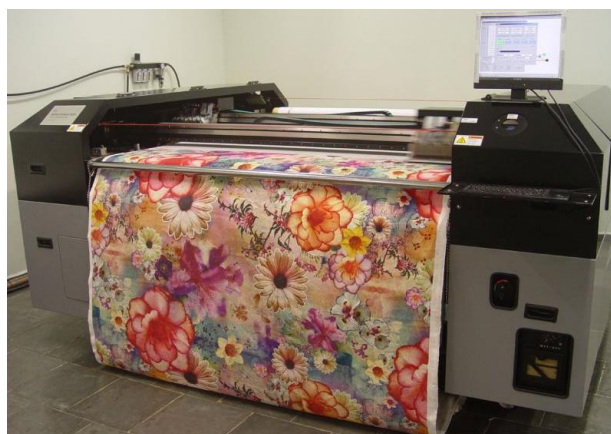
Figura 57 – Impressora de estamparia digital. Fonte: IMAH, 2011.
