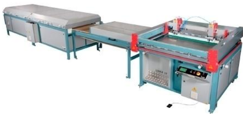
Figura 58 – Impressora para transfer sublimático. Fonte: IMAH, 2011.
