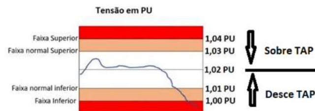
Fig. 1. Faixas limite de tensão.
