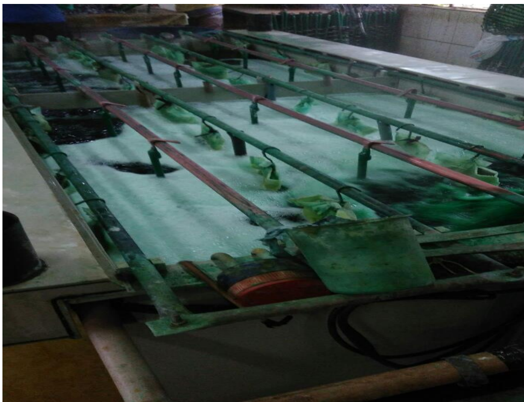
Foto 23 - Instalações da fábrica, máquina de metalização
