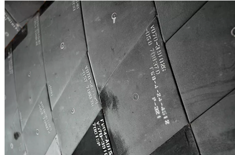
(b) Placas cerâmicas de revestimento do Space Shuttle
