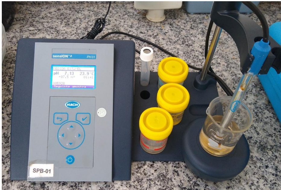
Figura 16. pHmetro modelo Sension+ PH 31 Lab da marca Hach.
