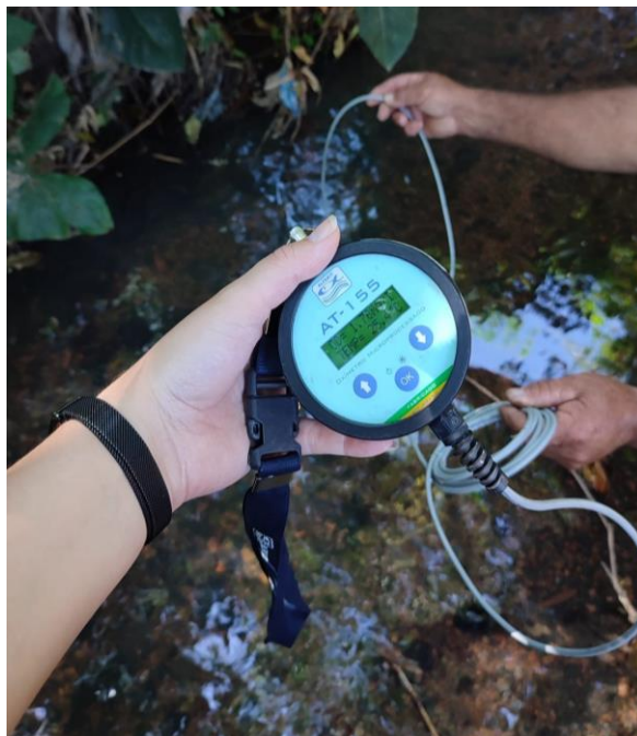
Figura 15. Oxímetro microprocessado modelo AT-155 da marca Alfakit
