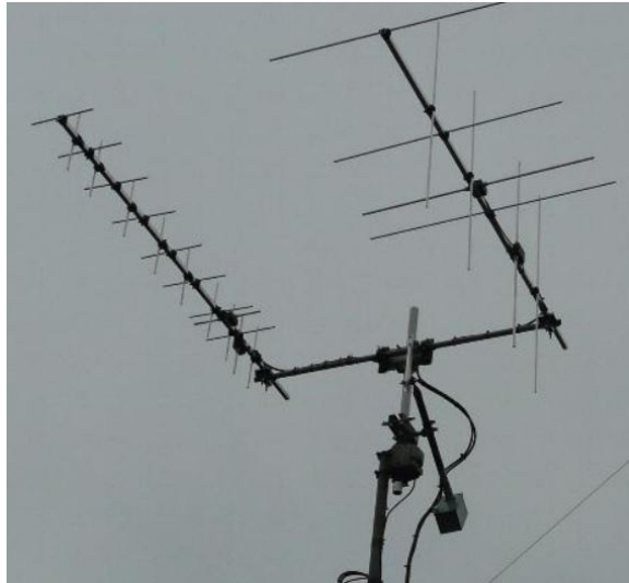
Figura 4.2 – Arranjo com duas antenas yagi circularmente polarizadas.
