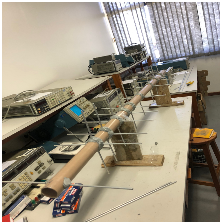
Figura 5.8 – Antena em construção.
