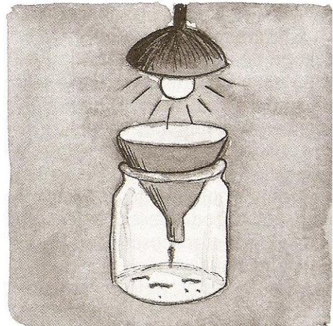
Figura 3: vidro com funil e luz para examinar os seres vivos da terra.
