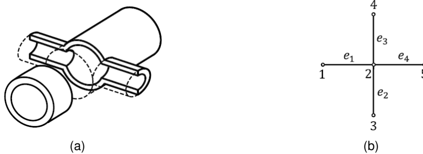
Figura 6 – (a) Dutos interconectados e (b) respectivo modelo unidimensional.
