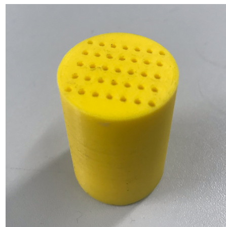
Figura 21 – Material impresso com camadas de 0,1 mm.
