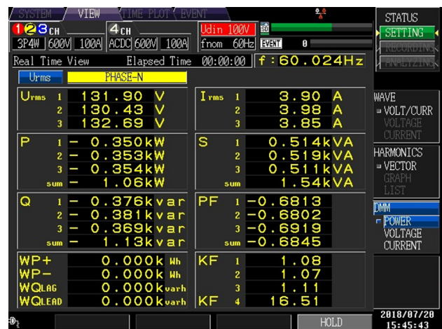
Figura 8. Resultados experimentais obtidos por meio do analisador de redes elétrica, modelo Hioki PQ3100, conectado no PAC.
