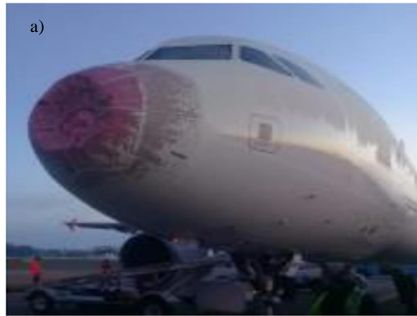
Figura 1.2 (a) Daños provocados por granizo severo el 31/10/2018. Planificación del vuelo SBGR (Guarulhos, Brasil) SCEL (Santiago de Chile); (b) Daños provocados por tormenta severa el 27/10/2022. Planificación del vuelo SCEL -SGAS (Asunción, Paraguay)
