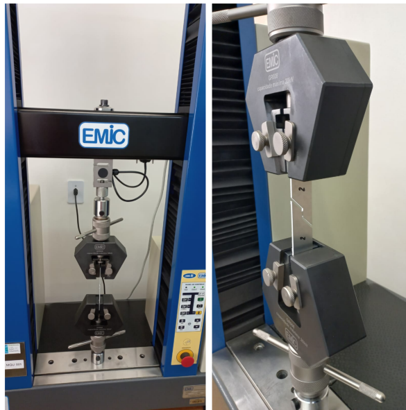
Figura 8 – Máquina de ensaio universal EMIC DL2000
