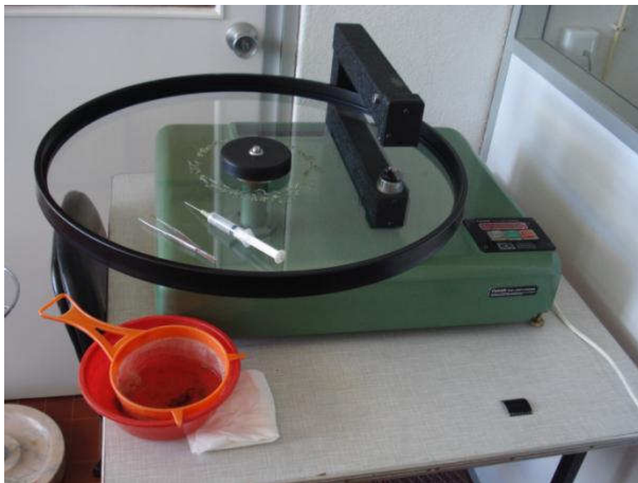
Figura 5 – Medidor fotoelétrico de raízes, modelo "Comair" (ROWSE; PHILIPPS, 1974). Fonte: arquivo pessoal.
