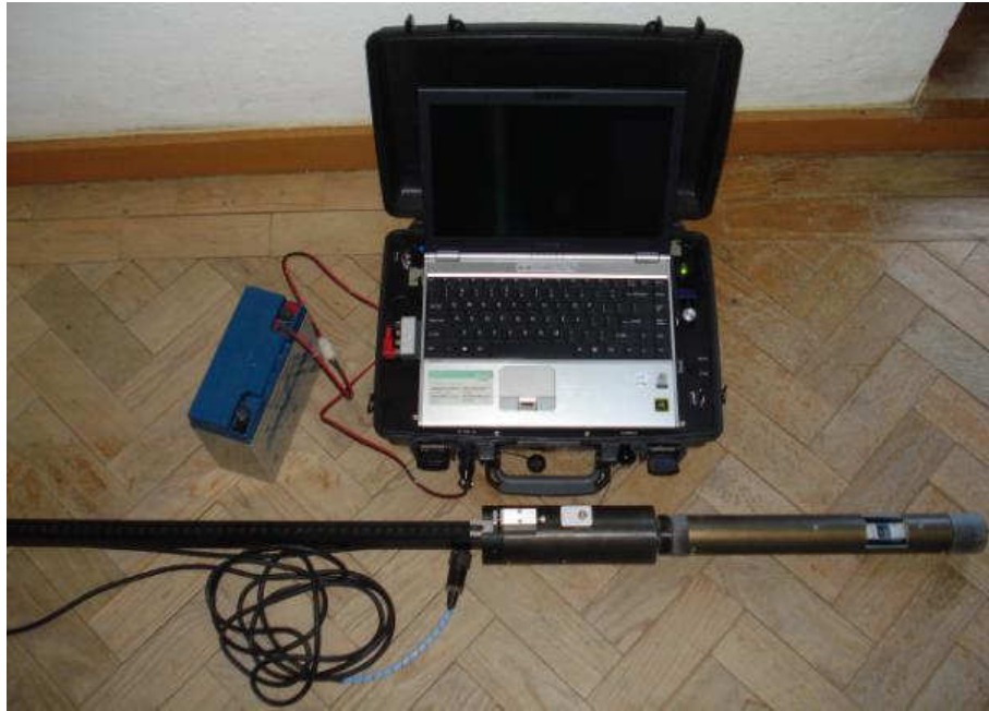
Figura 6 – Equipamento minirhizotron utilizado para observações do sistema radicular do meloeiro. Fonte: arquivo pessoal.
