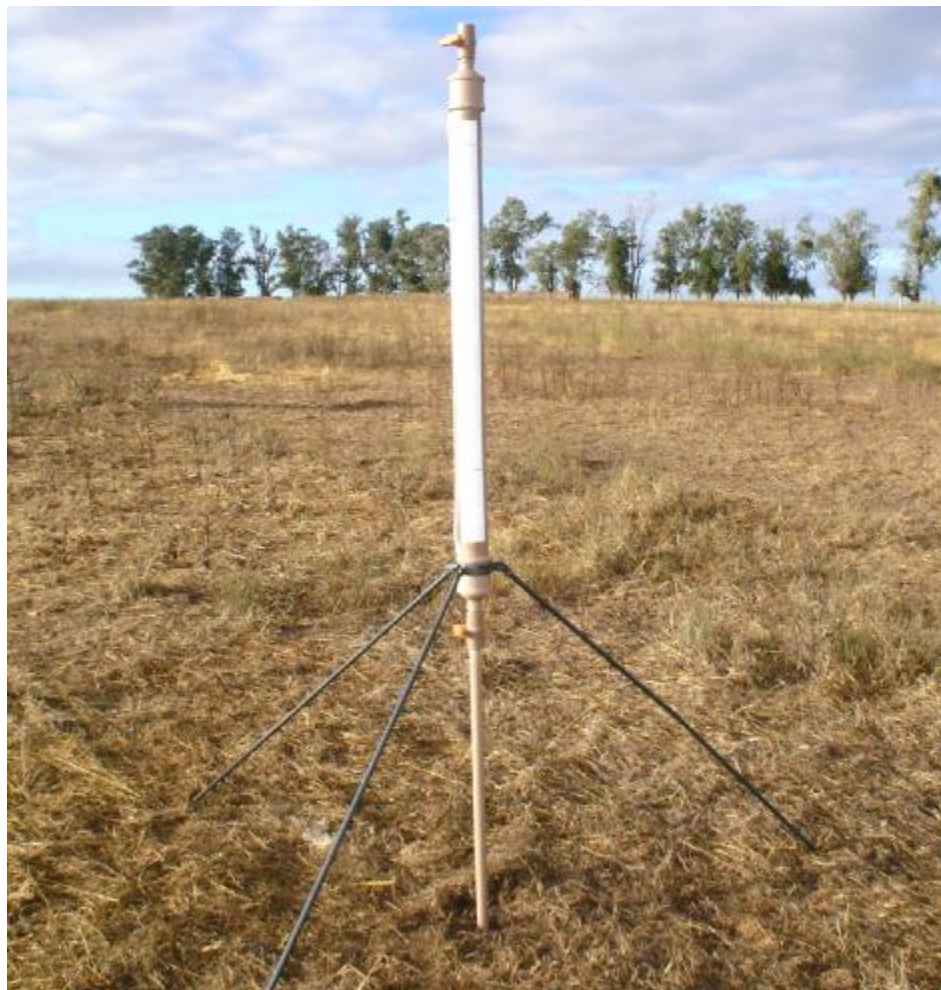
Figura 05- Detalhe do cano de PVC (permeômetro de Guelph) utilizado para a determinação da condutividade hidráulica em solo saturado. Santa Maria, RS, 2008.
