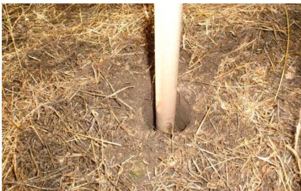
Figura 06- Detalhe do orifício utilizado para a determinação da condutividade hidráulica em solo saturado. Santa Maria, RS, 2008.
