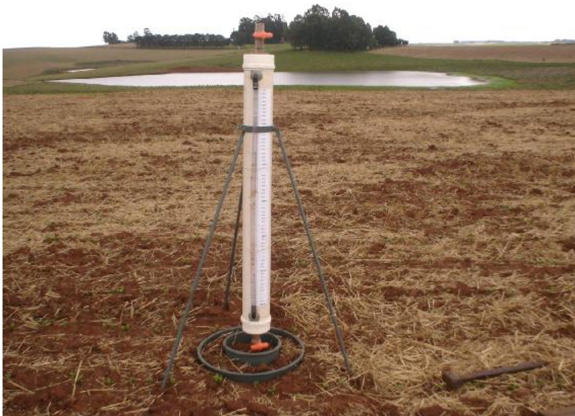
Figura 02- Detalhe dos duplos anéis concêntricos e do cano de PVC utilizados para a determinação da infiltração de água no solo. Santa Maria, RS, 2008.
