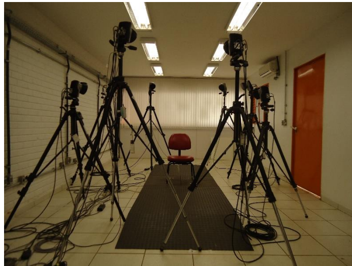
Figura 5 - Arranjo experimental - set de coleta com câmeras do sistema Qualisys (QTM - Qualisys Track Manager).
