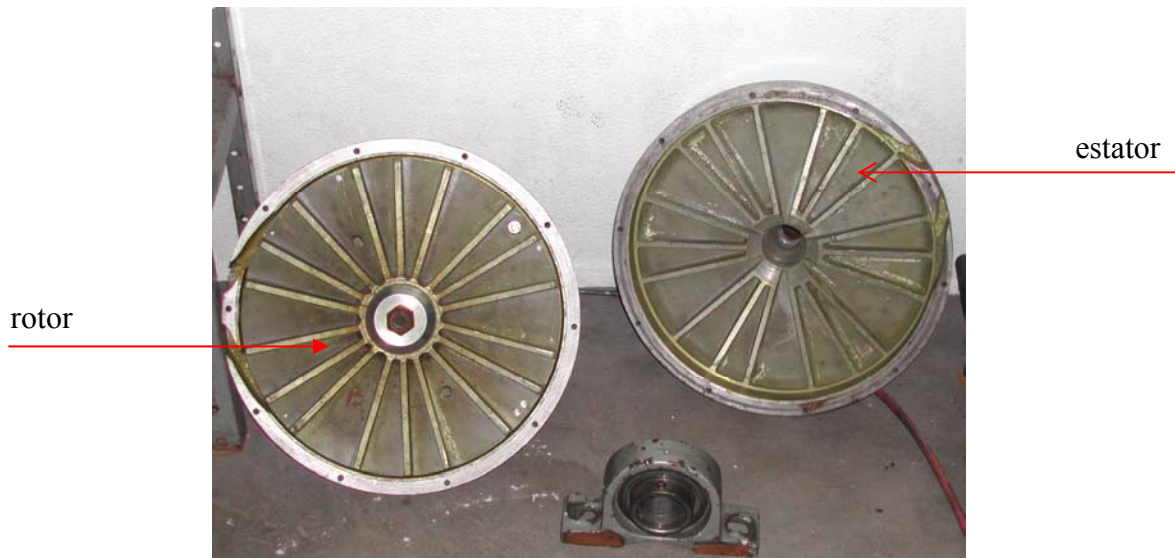
Figura 8 – Detalhe do estator e do rotor do dinamômetro hidráulico utilizado
