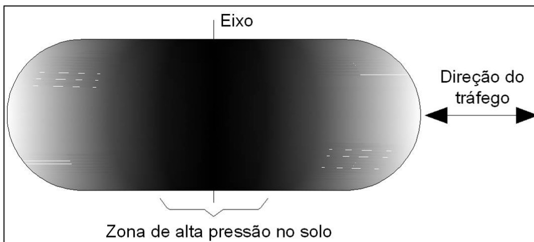
Figura 33 - Área de contato de um pneu com nítida diferença da pressão de contato (modificado por ZIESAK; MATTHIES, 2001).
