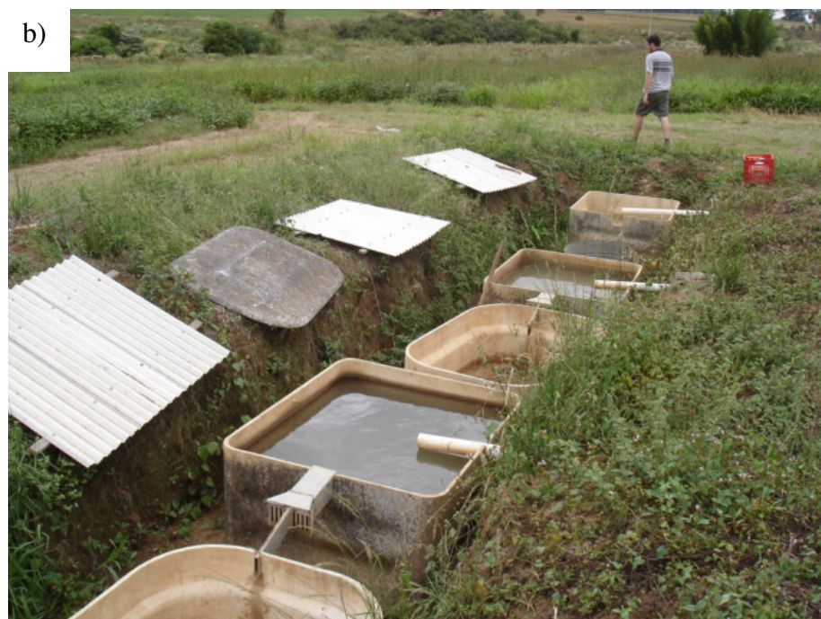
Anexo I. Detalhe das calhas coletoras de enchurradas localizadas na parte inferior das parcelas experimentais (a) e da trincheira onde estão alocadas as caixas para armazenamento do solo e água advindos das parcelas (b).
