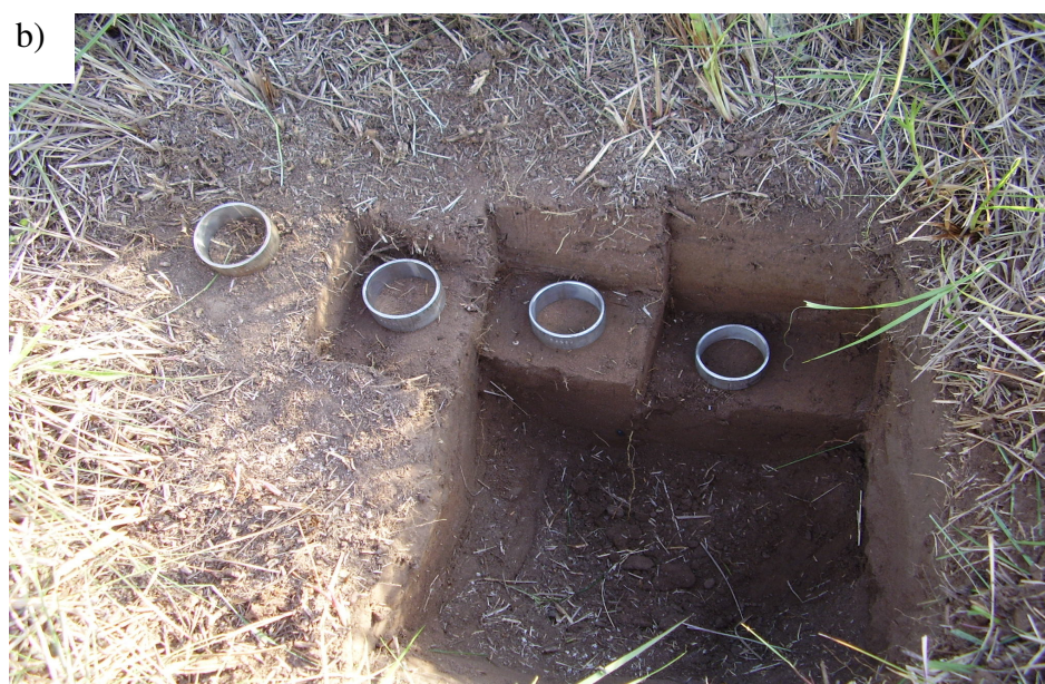
Anexo E. Detalhe da determinação da taxa de infiltração de água no solo, pela metodologia dos duplos anéis concêntricos (a), e da coleta de amostras para determinação da densidade e porosidade do solo (b).
