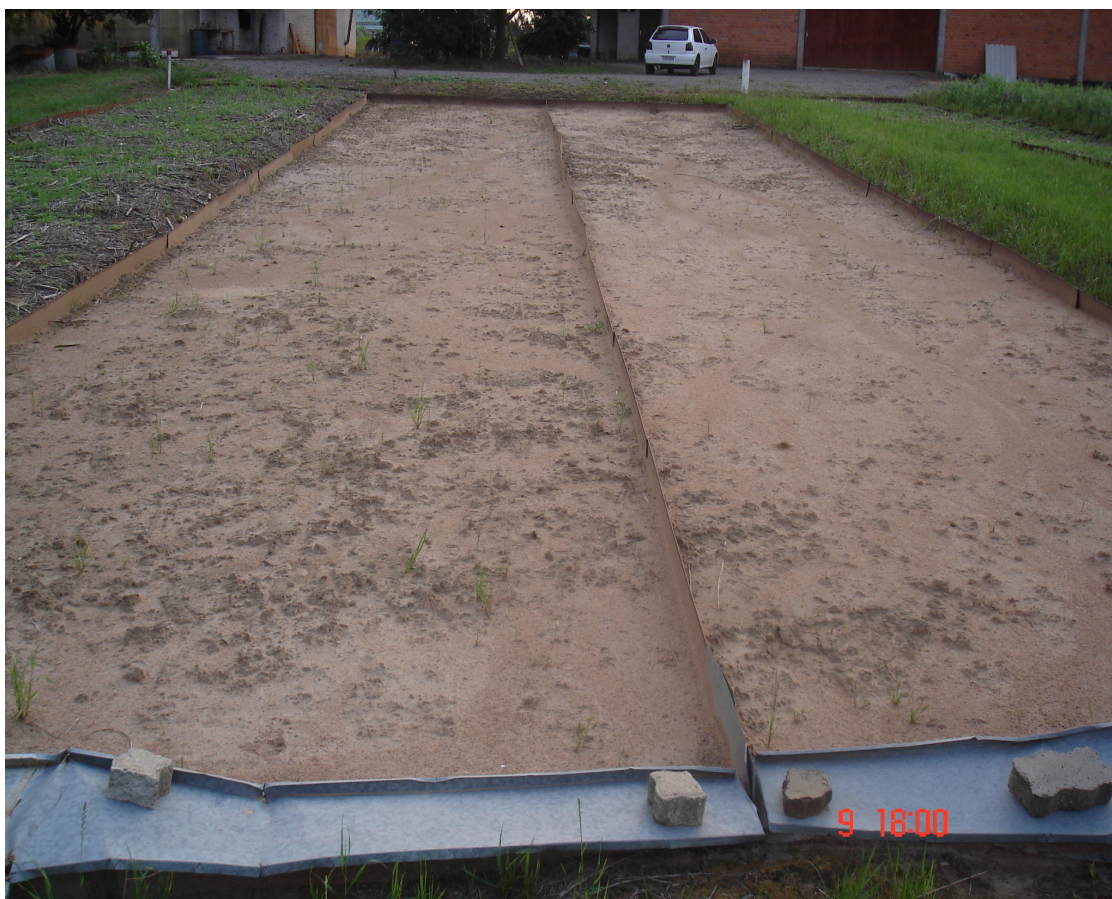
Figura 34. Detalhe das parcelas experimentais onde foram instalados os tratamentos solo descoberto (SDES, duas parcelas ao centro), milho + feijão de porco/soja (MFP, no canto superior à esquerda), e, pousio (POU, no canto superior à direita). *Entre os tratamentos SDES e POU há um espaço com vegetação natural, onde se pode comparar o desnível entre as parcelas ocasionado pela ocorrência contínua de erosão hídrica.
