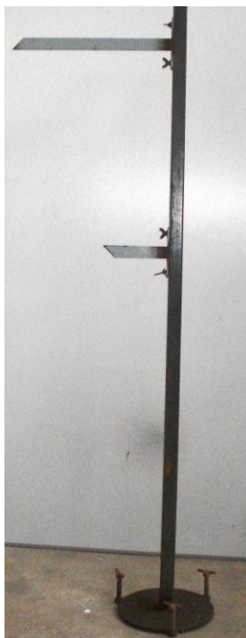
Figura 10 - Equipamento auxiliar de medição dos parâmetros dos pneus.
