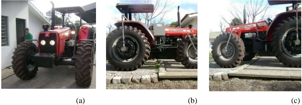
Figura 9 - Determinação da massa total (a), do eixo dianteiro (b) e do eixo traseiro (c) para dimensionamento da distribuição do peso.
