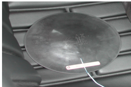
Figura 28: Acelerômetro triaxial fixado em placa de borracha rígida e plana
