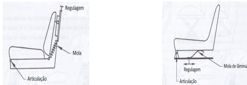
Figura 02: Banco com suspensão mecânica compacta por mola helicoidal (a); banco com suspensão mecânica compacta por mola de lâmina (b) Fonte: Donati (1996)
