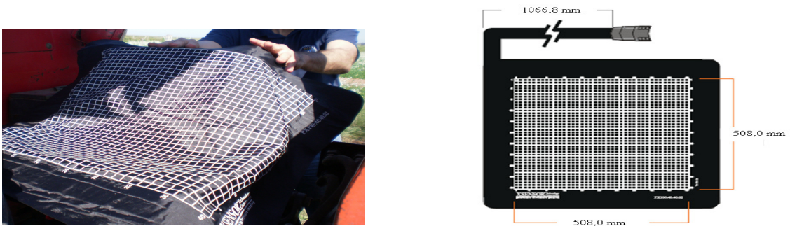
Figura 32: Manta sensorizada posicionada sobre o assento do banco (a); dimensões da manta utilizada (b)
