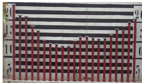
Figura 27: Perfilômetro mecânico utilizado nos ensaios
