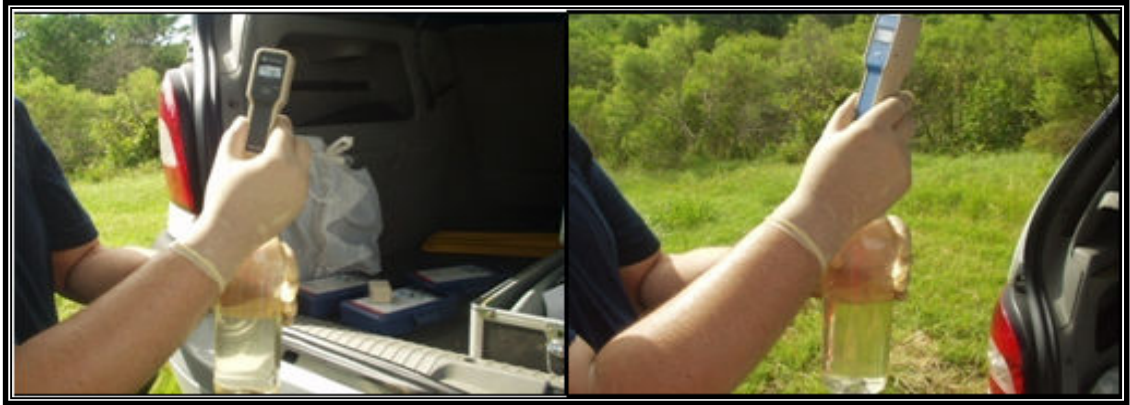
Figura 3.7 – Medida “in situ” da condutividade elétrica, pH e sólidos dissolvidos totais.
