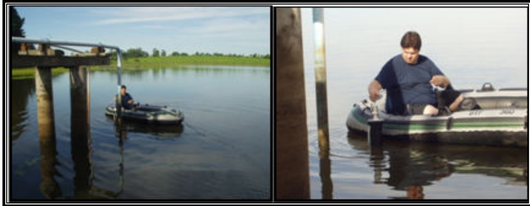
Figura 3.3- Momento da coleta de água através de garrafa de Kemmerer.
