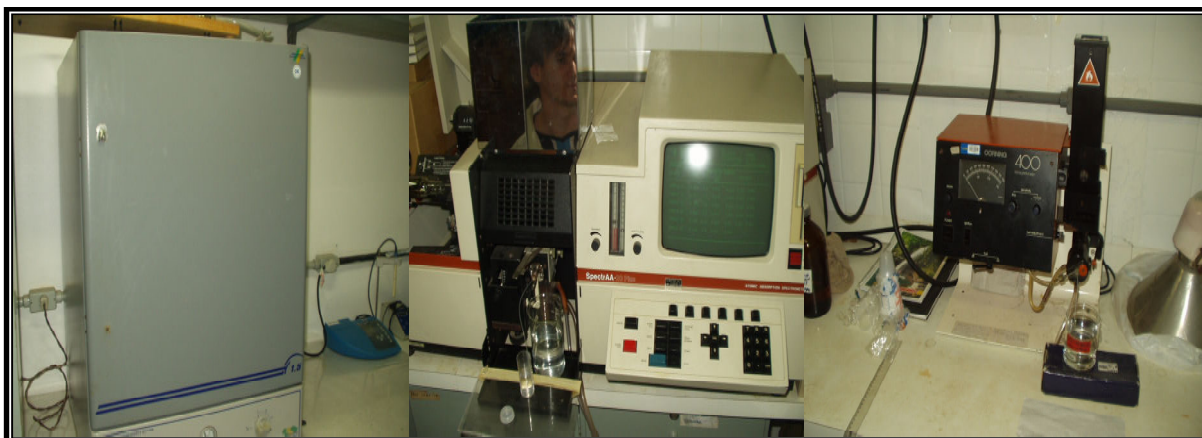
Figura 3.6 – Estufa, espectrofotômetro de absorção atômica e espectrofotômetro usados na análise laboratorial.
