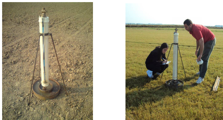
Figura 3.8 – Detalhe dos duplos anéis concêntricos e do infiltrômetro utilizados para a determinação da infiltração de água no solo. Santa Maria, RS, 2010.
