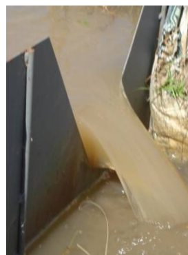
Figura 3.4 – Croqui e Vertedor triangular em metal. Santa Maria, RS, 2010.
