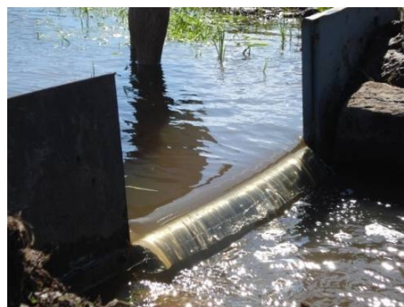
Figura 3.2 – Croqui e Vertedor Retangular em metal. Santa Maria, RS, 2010.
