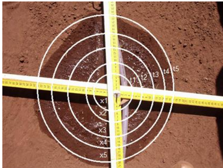
Figura 9 – Detalhe do avanço da frente de molhamento x em função do tempo t . Santa Maria, RS, 2006.
