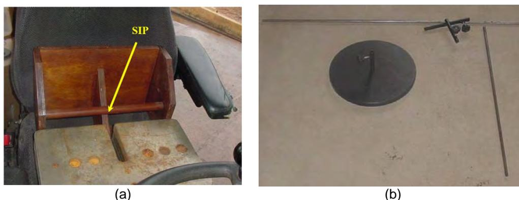
**Figura 1-** Dispositivos utilizados para medição das distâncias dos comandos até o SIP: (a) Dispositivo para simulação do SIP; (b) Equipamento de medida do SIP aos órgãos de comando (Fonte: FONTANA, 2005)
