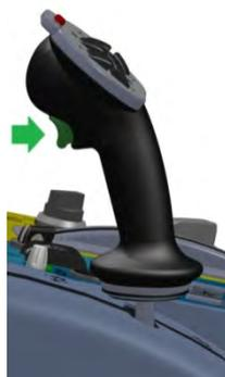
**Figura 79** - Dispositivo de proteção contra acionamento acidental disponibilizado no joystick
