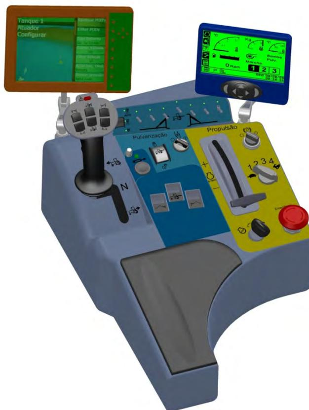
**Figura 80** - Conceito desenvolvido para o painel lateral
