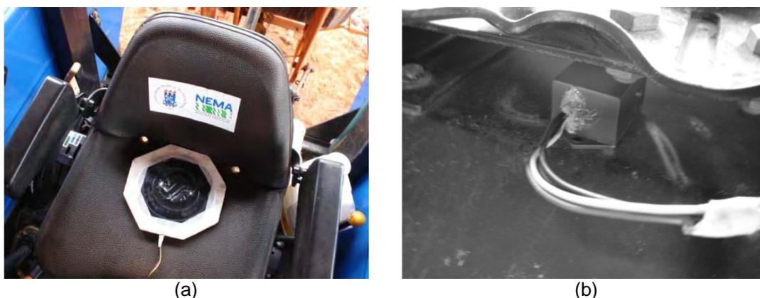
**Figura 4** - Acelerômetros do tipo capacitivo utilizados para medição da vibração em trator agrícola: (a) Acelerômetro instalados na interface operador-assento; (b) Acelerômetro instalado na base do assento (Fonte: FRANCHINI, 2007)
