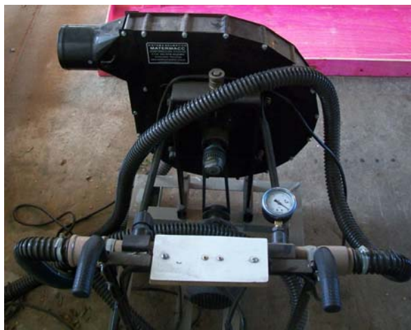
Figura 6 – Bancada geradora de pressão negativa composta por ventilador centrífugo, motor elétrico trifásico, vacuômetro (escala de 10 kPa) e controlador de vácuo.
