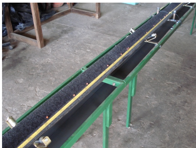
Figura 4 - Esteira carpetada com sementes de soja depositadas, mostrando detalhes da estrutura, rolos formadores de sulco e fita métrica.
