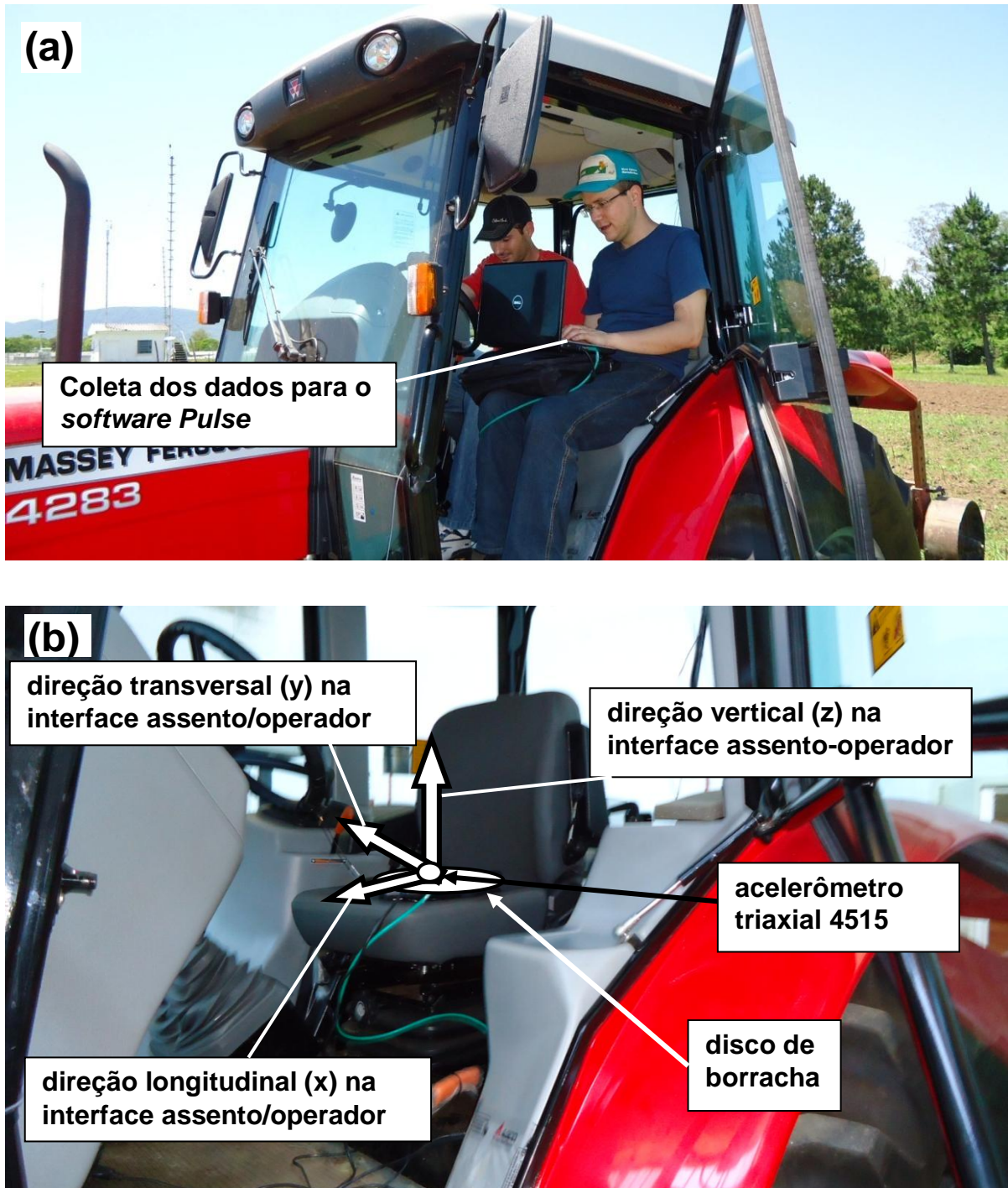
Figura 47 - Obtenção dos dados de vibração: a) registro das acelerações no interior do trator; b) direções de obtenção das acelerações tridimensionais na interface assento-operador
