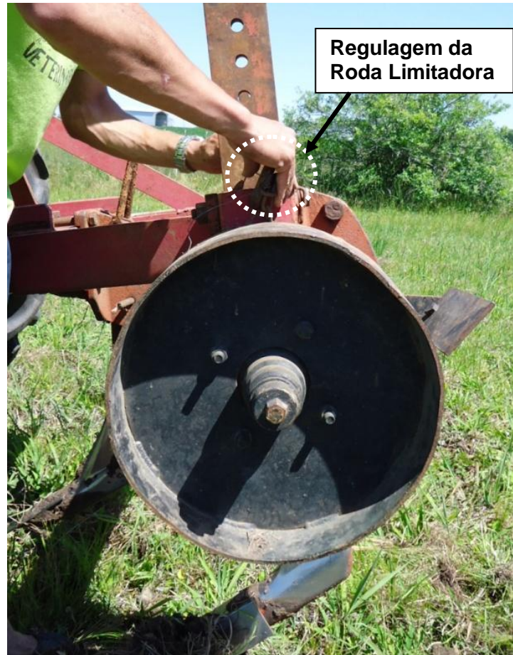
Figura 36 – Regulagem da roda limitadora de profundidade
