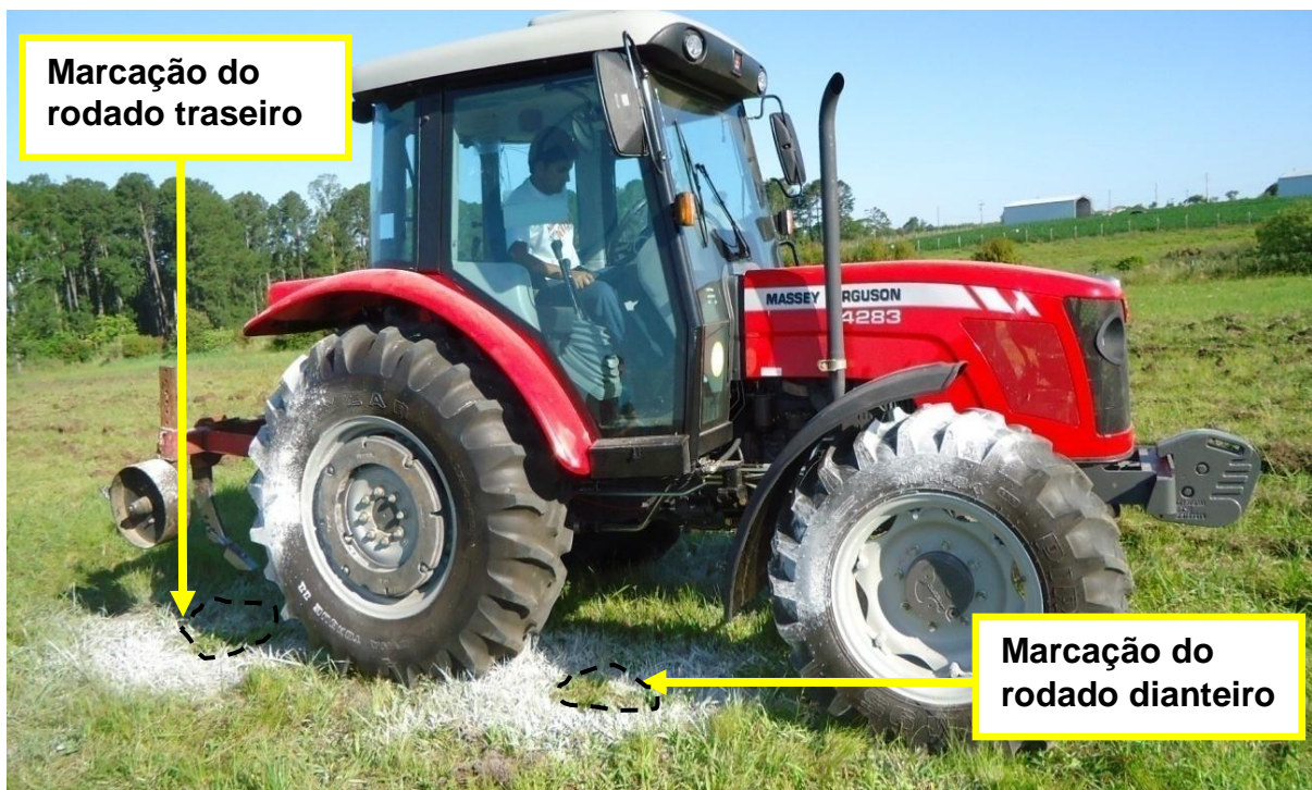
Figura 38 - Solo e pneu marcados com a cal para a obtenção da área de contato
