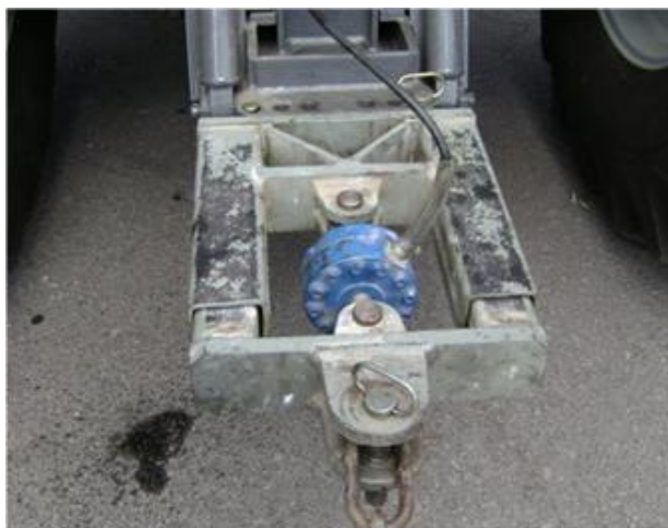
Figura 9 – Sistema de engate e célula de carga para medição da força de tração.
