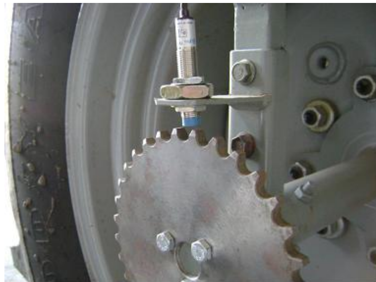
Figura 10 – Detalhe da roda dentada e sensor do tipo indutivo.
