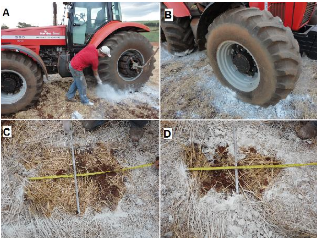
Figura 5 – Determinação da superfície de contato pneu com o solo: a) solo e pneu sendo marcados com cal branca para delimitação da área de contato; b) marcação do rodado dianteiro; c) medição das dimensões da elipse do rodado traseiro; d) medição das dimensões da elipse do rodado dianteiro.
