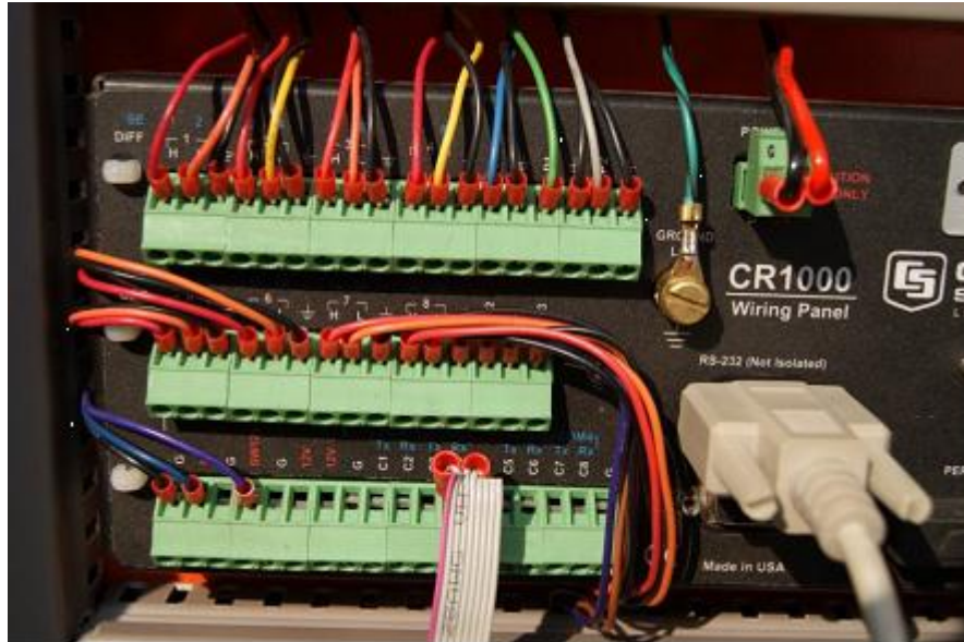
Figura 8 – Datalogger para armazenamento dos dados adquiridos pelos sensores.
