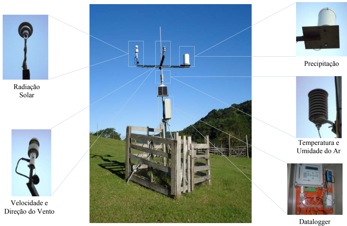
Figura 9 – Estação meteorológica instalada na área de campo nativo, com respectivos sensores de precipitação, pressão atmosférica, velocidade e direção do vento, radiação solar, temperatura e umidade relativa do ar.
