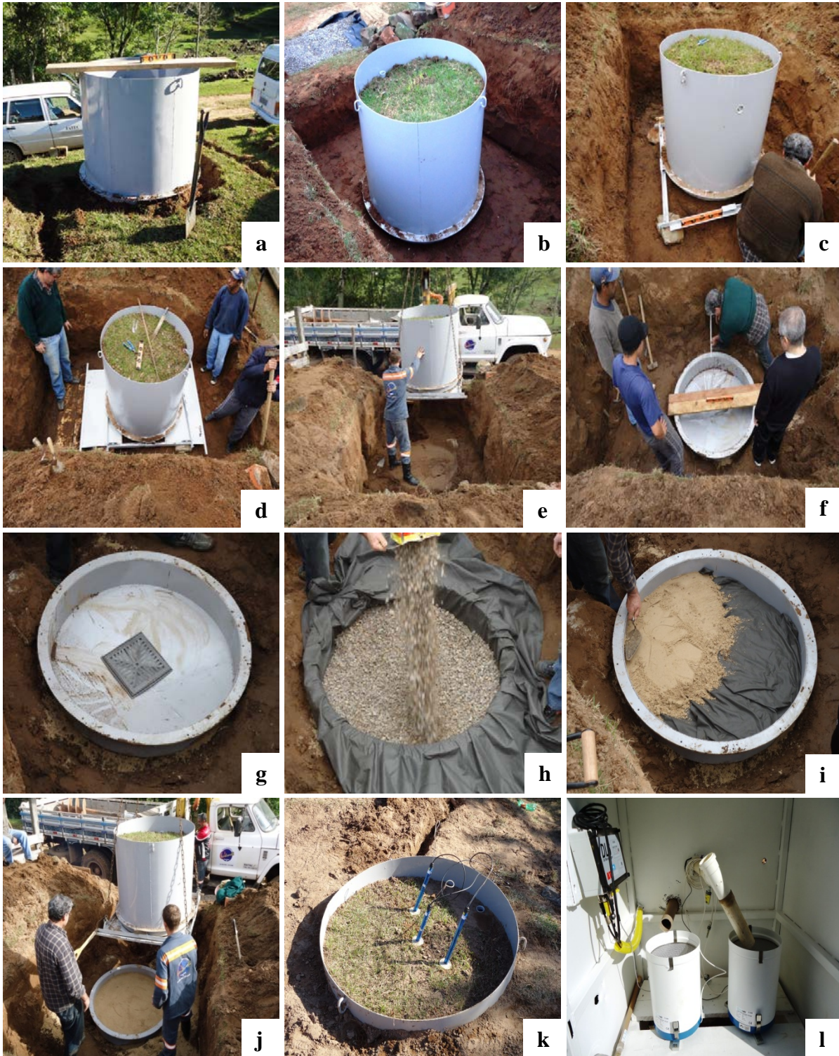
Figura 4 – Etapas de instalação do lisímetro de drenagem na área de campo nativo: a. posicionamento no local escolhido; b. abertura da trincheira; c. montagem da estrutura para elevação do lisímetro; d. introdução das lâminas e corte do solo; e. elevação do lisímetro; f. instalação da base do lisímetro; g, h, i. confecção do sistema de drenagem; j. colocação do lisímetro sobre a sua base; k. lisímetro com tensiômetros eletrônicos já instalados; l. pluviógrafos utilizados para monitoramento do escoamento superficial e drenagem resultantes.
