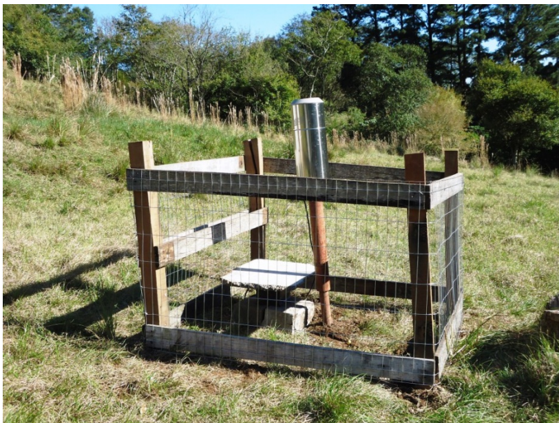
Figura 8 – Pluviógrafo de balança utilizado no monitoramento da precipitação externamente a mata nativa.
