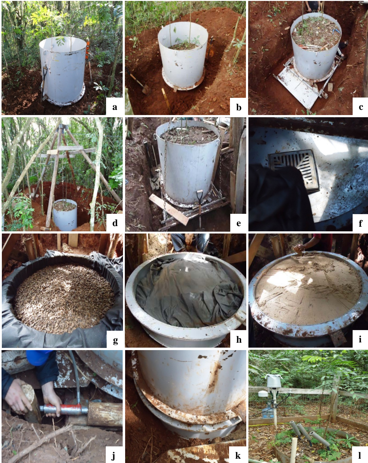
Figura 5 – Etapas de instalação do lisímetro de drenagem na área de mata nativa: a. escolha do local de instalação; b. abertura da trincheira; c. introdução das lâminas e corte do solo; d. montagem da estrutura para elevação do lisímetro; e. lisímetro sendo suspenso; f, g, h, i. confecção do filtro; j. retirada das laminas com macaco hidráulico; h. união das partes que compõe o lisímetro; l. lisímetro já instalado, com tensiômetros instalados e vegetação interna inalterada.
