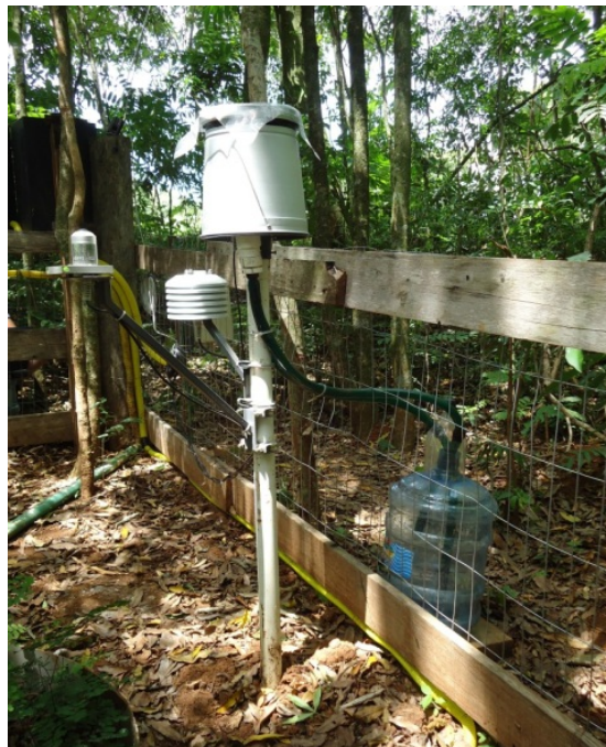
Figura 10 – Pluviógrafo com respectivos sensores para monitoramento da radiação solar, temperatura e umidade relativa do ar no interior da mata nativa.
