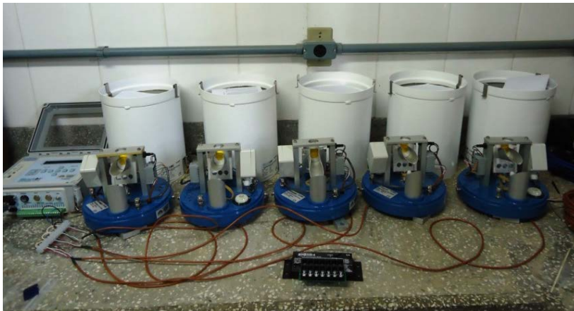
Figura 7 – Pluviógrafos de balança utilizados no monitoramento da precipitação, escoamento superficial e drenagem nos lisímetros.
