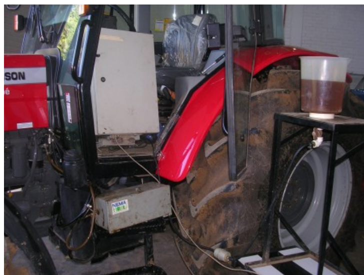
Figura 3.3: Combustível (direita), fluxômetro (abaixo) e datalogger (acima).
