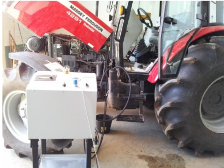
Figura 3.5: Fluxômetro Eggers FM3 (à frente) instalado no trator.
