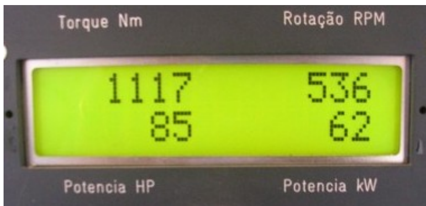
Figura 4.15: Monitor do controle manual de rotação e torque do motor pelo dinamômetro.
