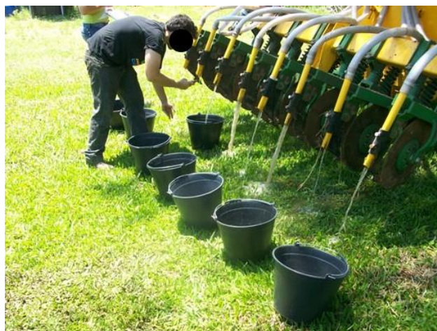
Figura 15 - Experimento e teste para determinação de vazão nas linhas de distribuição
