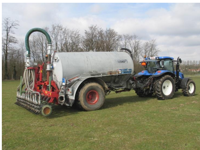
Figura 7 - Equipamento utilizado para injeção de DLS
