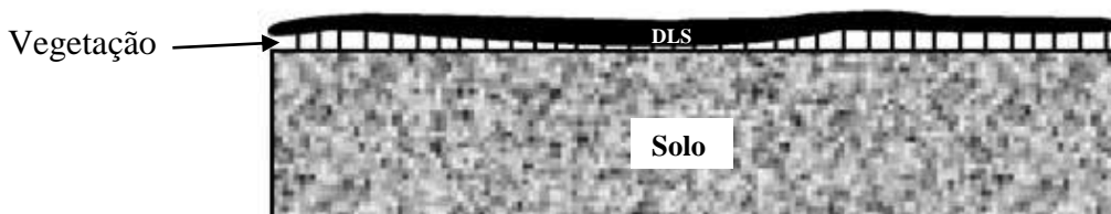
Figura 1 - Representação esquemática da aplicação de DLS na camada superficial do solo, através de uma tubulação com bocal
