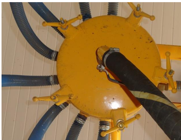
Figura 48 - Tubo de saída de DLS (08) - Subsistema Distribuidor
