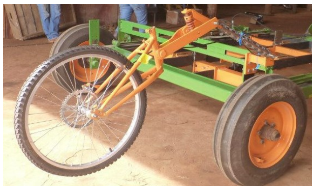
Figura 9 - Roda odométrica acoplada na estrutura porta-ferramentas.
