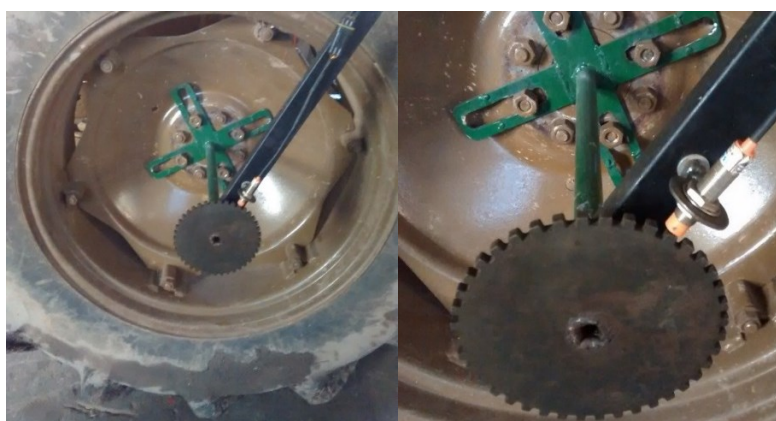
Figura 8 - Estrutura de acoplamento do sensor indutivo.
