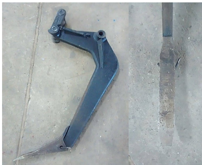
Figura 10 - Haste e ponteira do elemento descompactador reto inclinado.
