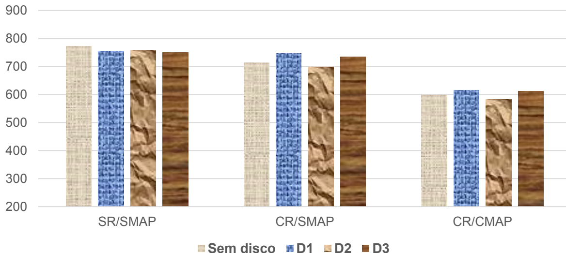
Figura 30 - Ilustração dos valores encontrados de área de solo mobilizado para a interação entre os fatores distância do disco para o elemento descompactador e acondicionamento de palha.
