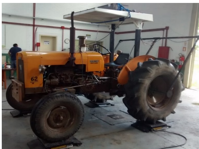
Figura 5 - Trator utilizado no trabalho com instrumentação eletrônica acoplada.
