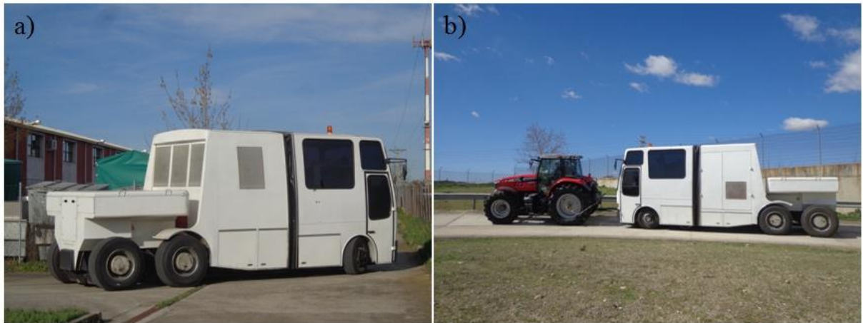
Figura 15 - Carro dinamométrico utilizado para avaliar o desempenho em tração dos tratores agrícolas: a) utilizado como veículo e b) utilizado como freio.
