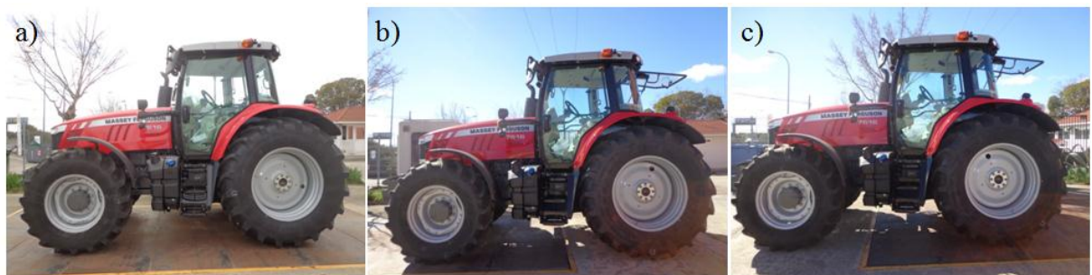
Figura 12 - Determinação das massas: a) total; b) do eixo dianteiro e c) do eixo traseiro, do trator MF 7616 Dyna-6.
