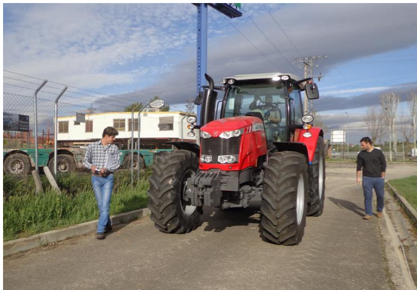
Figura 13 - Determinação da circunferência de rolamento do trator MF 7616 Dyna-6.
