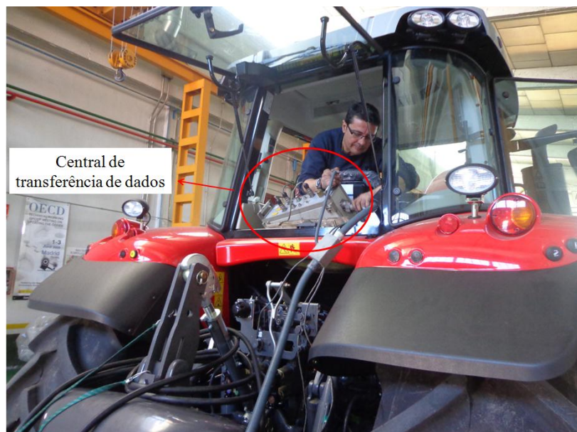
Figura 17 - Instalação da central de transferência de dados dos sensores do trator para o programa computacional do carro dinamométrico.
