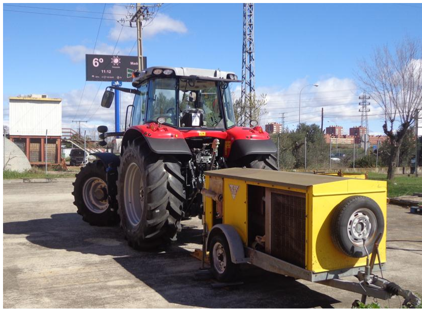
Figura 11 - Amaciamento do motor do trator MF 7616 Dyna-6, utilizando freio dinamométrico móvel, antes da realização dos experimentos.
