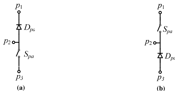
Figura 2-9. Pólos auxiliares: (a) somente comutações tipo boost e (b) somente comutações tipo buck .
