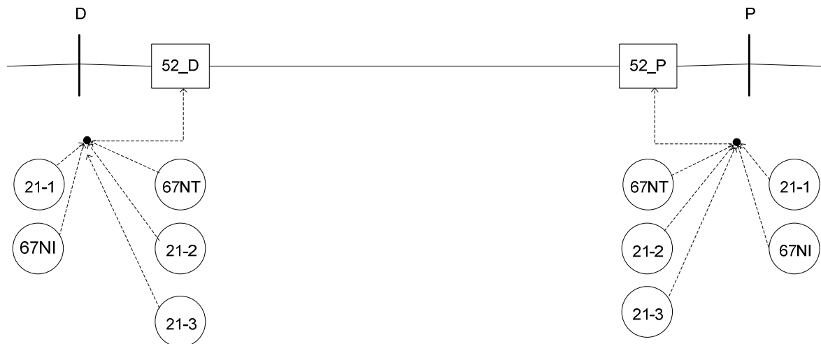
Figura 4.7 - Dispositivos de proteção associados às Linhas de Transmissão
