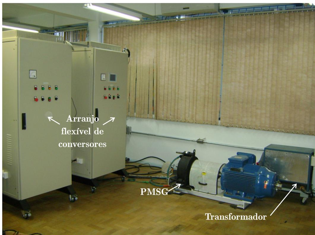
Figura 6.1 – Foto da bancada experimental.
