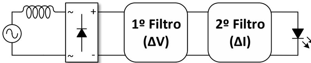
Figura 2.5 – *Driver* do tipo CC com filtro de tensão e corrente
