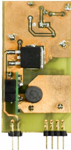
Figura 8.14 – Foto da placa do sensor de corrente dos LEDs
