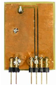
Figura 8.21 – Foto da placa de recepção
