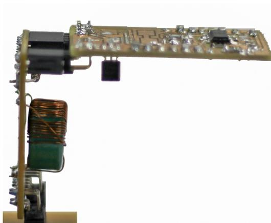
Figura 8.19 – Foto do sistema de leitura da corrente no interruptor
