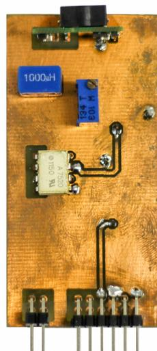
Figura 8.12 – Foto da placa do sensor de tensão
