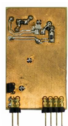
Figura 8.18 – Foto da placa de sensoriamento da corrente no interruptor
