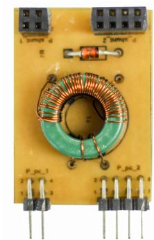
Figura 8.17 – Foto da placa do transformador de corrente
