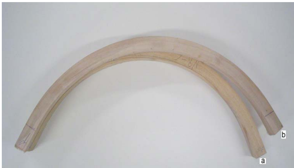
Figura 45 - Peça de madeira vergada: a) peça com raio original; b) peça com retorno no raio vergado.
