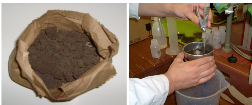
FIGURA 3 - Amostra de solo e sua lavagem, após agitação por 15 h, com jato d'água leve, para separação das frações em peneira de 0,063 mm. Freiburg, 2007.
