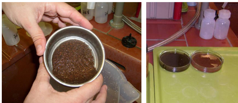
FIGURA 5 - Fração particulada (COP) retida na peneira de 0,063 mm e, posteriormente, transferida para placas de petry. Freiburg, 2007.
