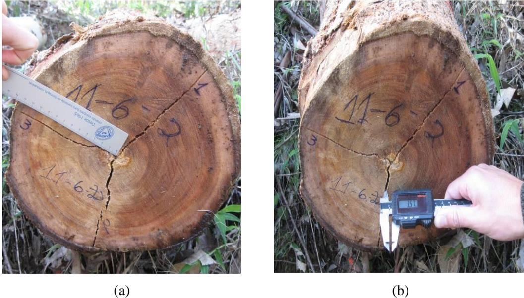
FIGURA 4.3 - Avaliação dos índices de rachaduras de topo das toras de *Eucalyptus* spp.; (a) comprimento das rachaduras na seção transversal; (b) abertura máxima no topo das toras.
