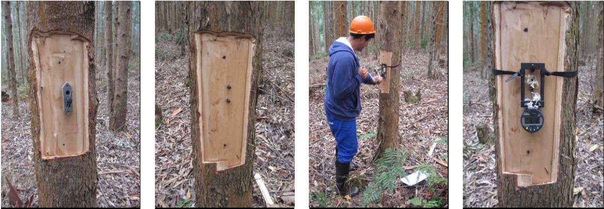
FIGURA 3.2 - Sequência (esquerda para direita) realizada para mensuração da deformação residual longitudinal nas árvores de *Eucalyptus* spp.
