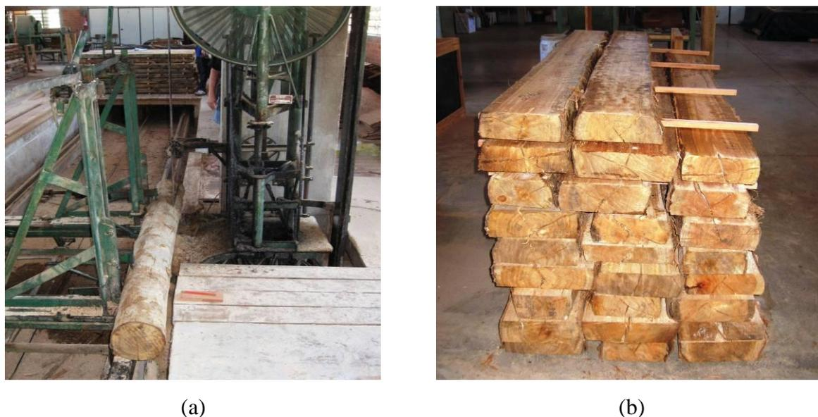
FIGURA 4.4 - Desdobro das toras de *Eucalyptus* spp.; (a) equipamentos utilizados; (b)pranchões destinados aos ensaios mecânicos.
