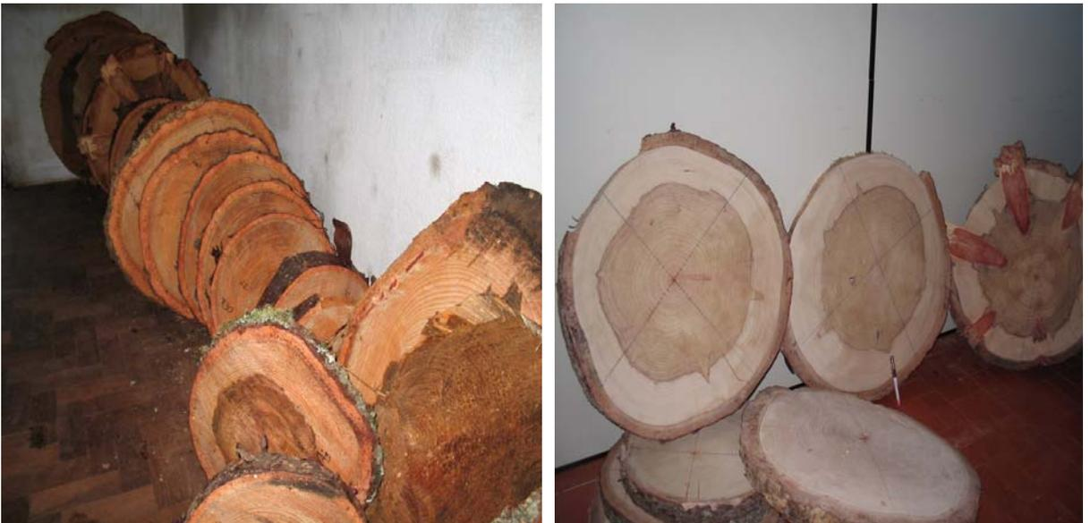
Figura 10 – Discos retirados para Análise de Tronco, "*in natura*", e após secos e lixados para medição.
