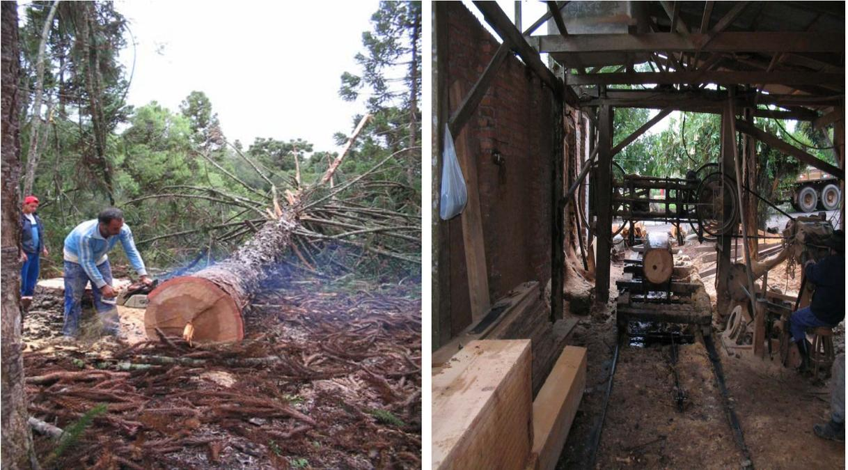
Figura 9 – Derrubada para retirada dos discos e desdobramento das toras em tábuas.
