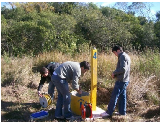
Figura 5.20- Aferição do nível do poço nº 4 com uso de freatímetro sonoro
