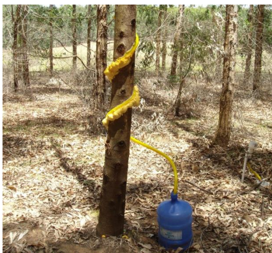
Figura 5.8 - Ilustração da técnica de coleta de água pelo tronco
