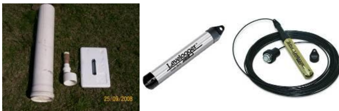
Figura 5.11 - Transdutor de pressão (sensor de nível, datalogger e bateria) utilizado.
