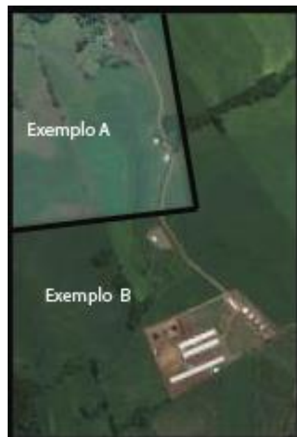
Figura 9 - Área de uso idêntico com resposta espectral diferenciada.
