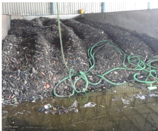
Figura 43 – Estágio intermediário do processo de compostagem
