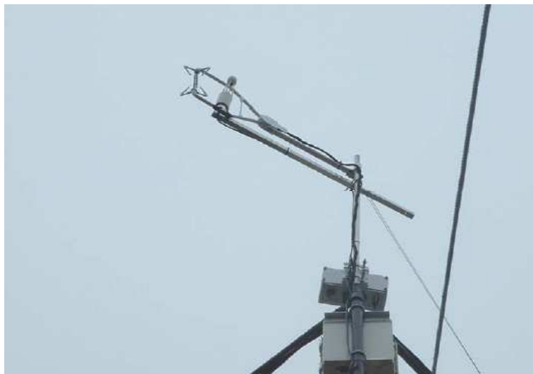
Figura 3.3: Sistema de covariância de vórtices: anemômetro sônico e analisador de gás infravermelho de caminho aberto.
